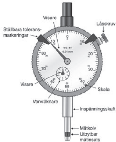
Figur 1.9 Mätur med linjärt arbetande mätkolv.
