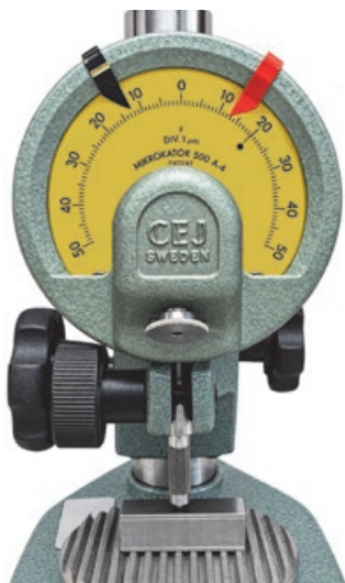
Figur 1.10 Mikrokator från C. E. Johansson. Siffrorna anger tusendels millimeter, varför passbitskombinationen visar en avvikelse på 20 \mu\text{m} från basmättet.
