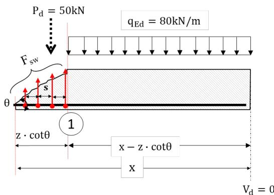
Figuren ovan visar jämviktsvillkoret. Skjuvarmeringen ska bära lasten från tvärkraftsnollpunkten till snittets övre kant.
